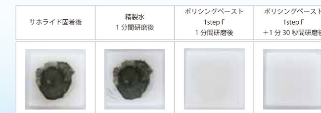
サハライド液歯科用 38% を固着させたアバタイトレットに対する清掃効果
